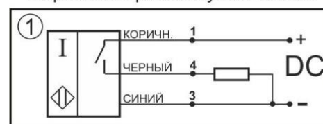
Цоколевка клеммной колодки
