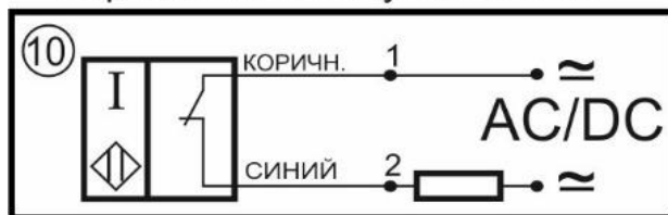
Схема соединения Нормально-замкнутый контакт
