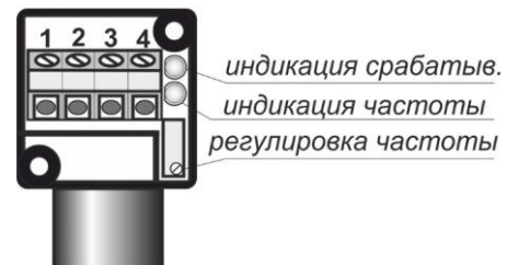
Цоколевка клеммной колодки
