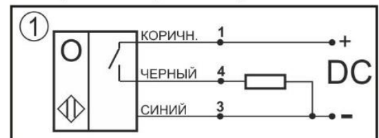
Цоколевка клеммной колодки
